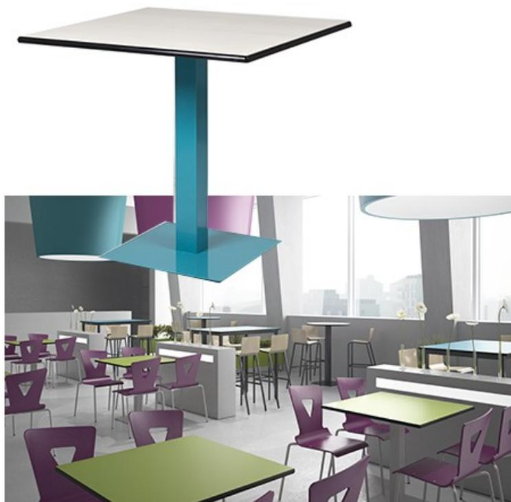
Table livrée démontée. Taille 6. Piétement monobloc acier. Montant carré 80 X 80 mm. Embase carrée ép. 8 mm munie de tampons de protection. Plateau stratifié épaisseur 22 mm avec chants alaisés bois : bordure en hêtre massif en applique sur le chant du plateau. Nombreux coloris de plateaux et de piétements, nous consulter. Existent aussi en plateau compact, nous consulter.
